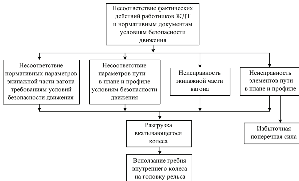
Рис. 3. Механизм влияния параметров на нарушение безопасности движения поездов при сходах вагонов внутрь кривой
