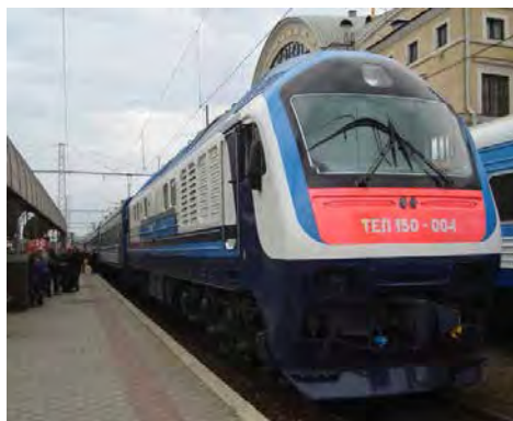
Рис. 1. Тяговый подвижной состав в конструкции колес которого применяются катаные колесные центры а – пригородный дизель-поезд ДЭЛ-02; б – пассажирский тепловоз ТЭП-150
