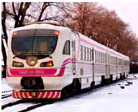
Рис. 1. Тяговый подвижной состав в конструкции колес которого применяются катаные колесные центры а – пригородный дизель-поезд ДЭЛ-02; б – пассажирский тепловоз ТЭП-150
