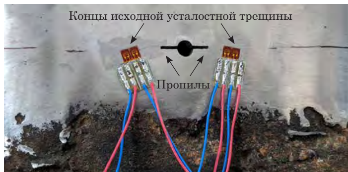
Рис. 2. Схема наклейки датчиков в окрестности концов исходной усталостной трещины по нижнему поясу надрессорной балки
