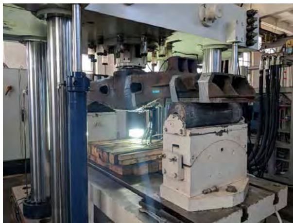
Рис. 1. Схема нагружения надрессорной балки в испытательной машине МДИ-2000
