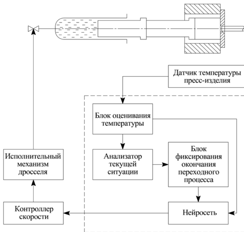
Рис. 6. Блок-схема системы управления скоростью прессования
