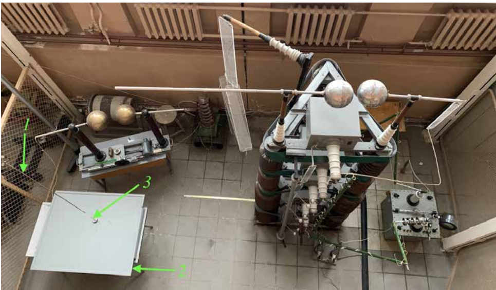
Рис. 7. Стенд для опытного определения зон молннезащиты молниеотводов в лаборатории ТВН УрГУПС
