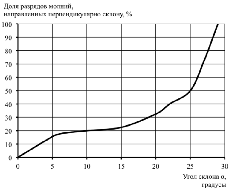
Рис. 8. Результаты опытного определения направления ударов молнии в молниеотвод, расположенный на склоне
