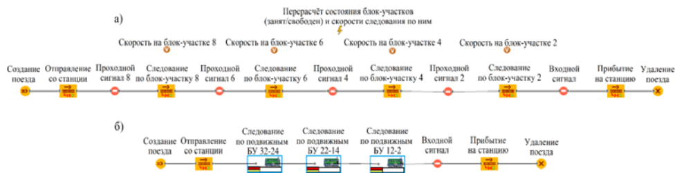
Рис. 3. Логика следования поезда по перегону, оснащённому автоблокировками ЧКАБ (а) и АБТЦ-МШ (б) в виде блоков процессного подхода ИМ
