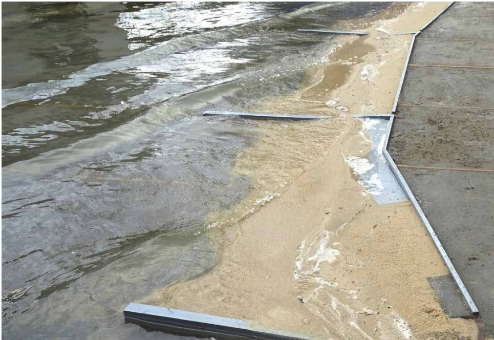
Рис. 4. Экспериментальные исследования пляжеудерживающей способности бетонных бун
