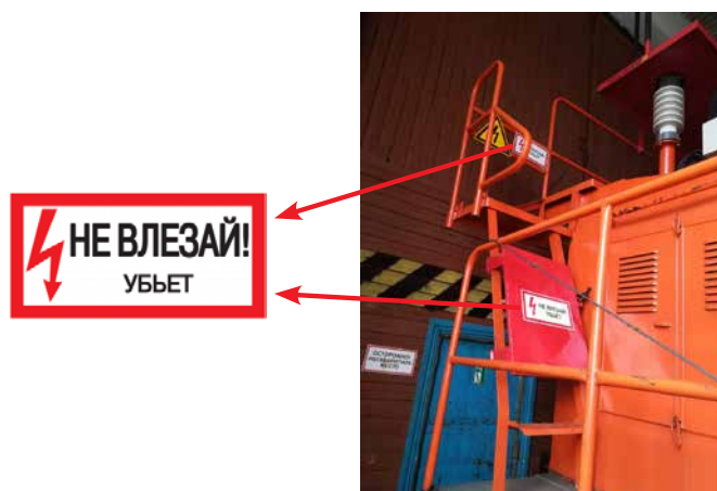
Рис. 2. Подъемная лестница автомотрисы, оснащенная знаками безопасности
