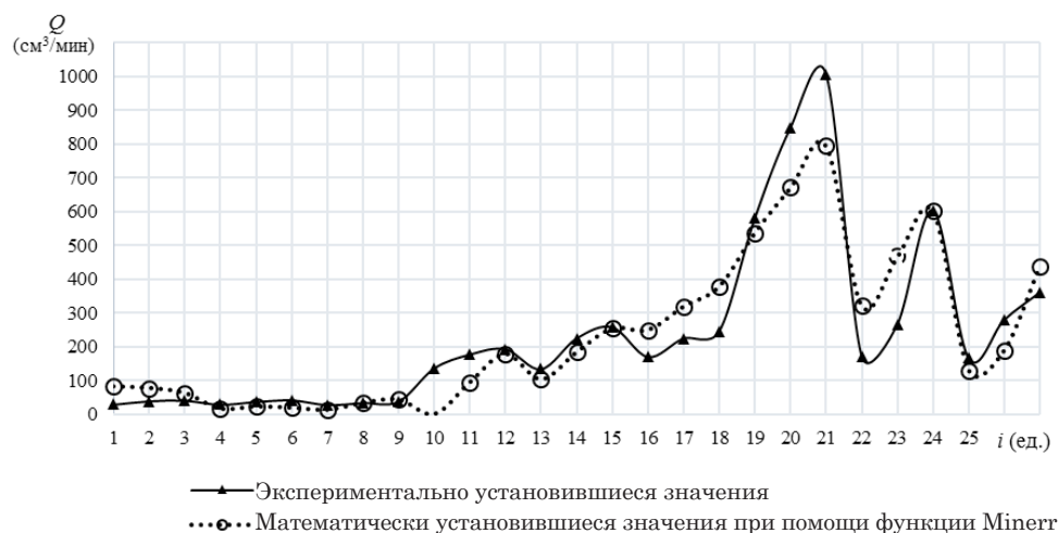
Рис. 5. Значения объема утечек топлива Q (см 3 /мин), полученные в ходе экспериментальных исследований с числом повторностей i (ед.) от 1 до 27
