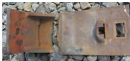
Рис. 2. Характерный вид разрушения подкладок контррельса
