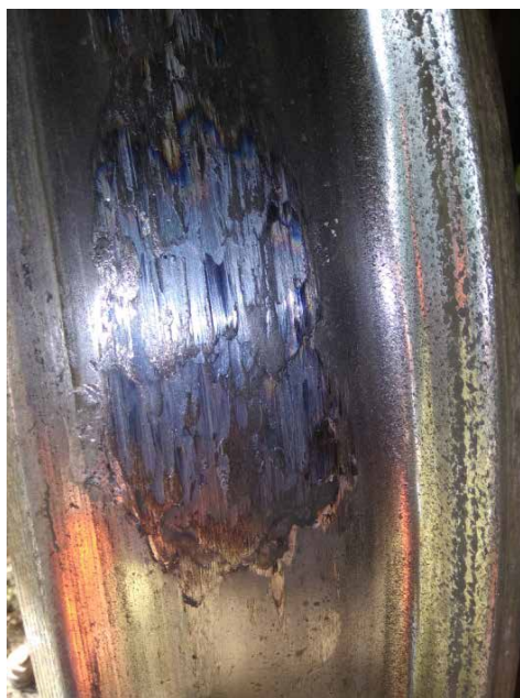
Рис. 3. Дефекты на поверхности колеса а – ползун при торможении вагона башмаком; б – выщербина на месте ранее образованного ползуна
