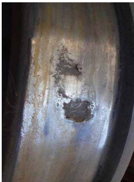
Рис. 3. Дефекты на поверхности колеса а – ползун при торможении вагона башмаком; б – выщербина на месте ранее образованного ползуна
