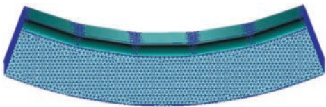
Рис. 3. Конечно-элементная модель неизношенной тормозной колодки в среде MSC Patran/Sinda
