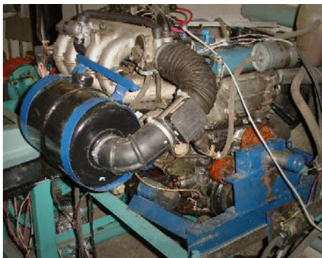
Рис. 2. Экспериментальный стенд (двигатель ЗМЗ-4062)
