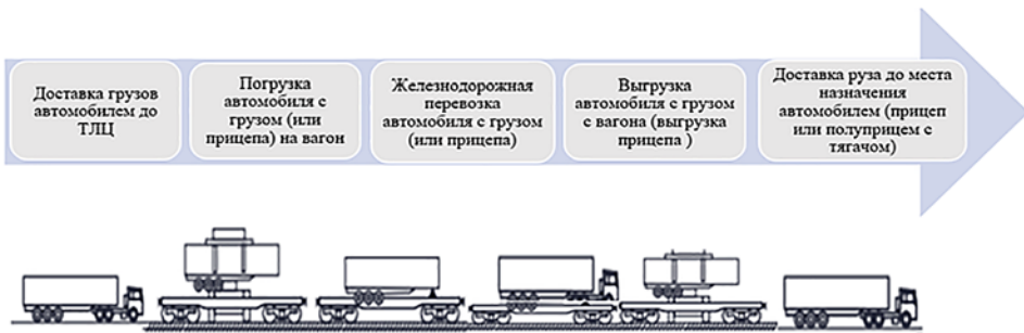
Рис. 1. Технологическая схема работы терминала по технологии «Lo-Lo»
