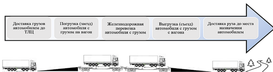
Рис. 2. Технологическая схема работы терминала по технологии торцевого заезда (съезда) автомобилей на вагоны
