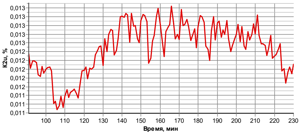
Рис. 8. Зависимость коэффициента несимметрии напряжений по обратной последовательности ( K_{2U} ) в течение 100 % времени измерения от времени на стороне 0,38 кВ для КТП-2
