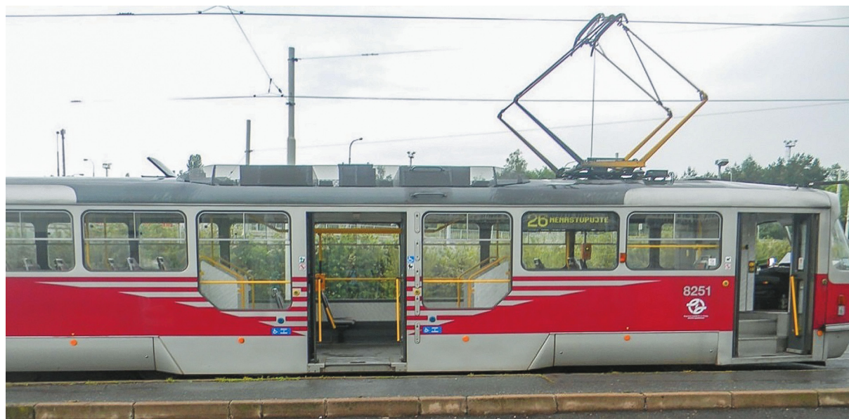
Рис. 2. Внешний вид трамвайного вагона Tatra T3R.PLF (модернизация с низким полом в середине вагона)
